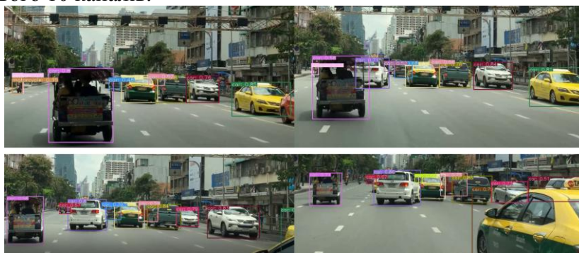
Рисунок 3. Візуалізація роботи розпізнавання об'єктів разом з відстеженням
