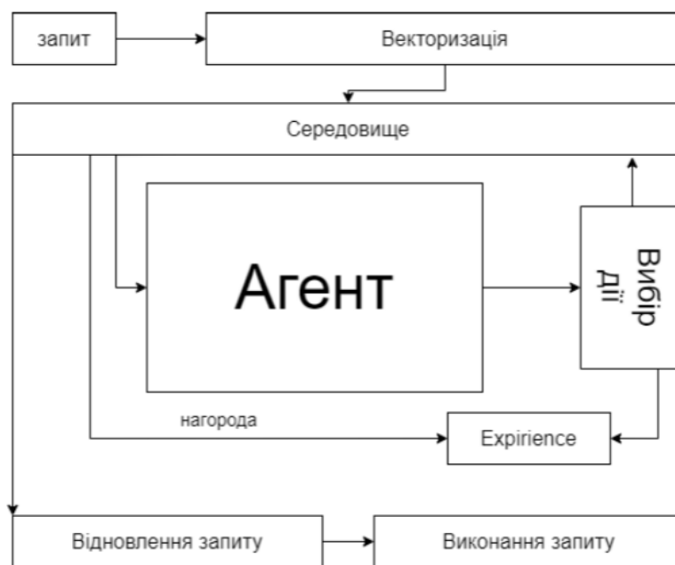
Рисунок 4. Схема використання навчання з підкріпленням для задачі створення оптимального порядку з'єднань
